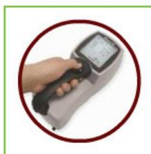
Peça aos seus alunos que olhem com atenção a imagem deste instrumento, apresentado na primeira tela, e explique que na Química o colorímetro possibilita a determinação da absorvância de uma solução em uma frequência particular determinada por cor.
