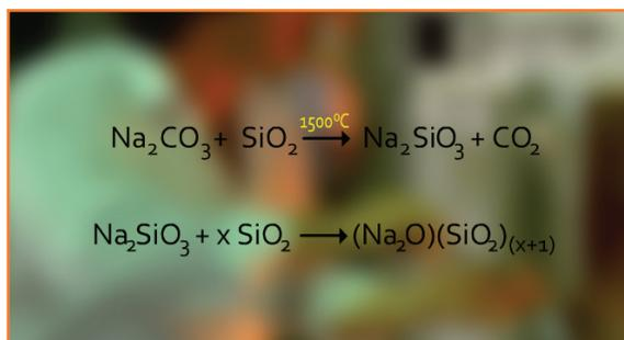
Estes elementos combinados e postos em altíssimas temperaturas irão reagir entre si e tomar uma forma líquida. Durante o resfriamento rápido desse líquido, pode-se moldá-lo e dar a forma desejada ao vidro.
