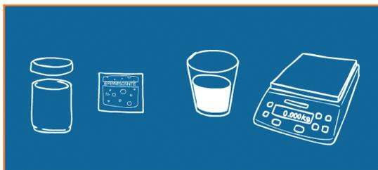
Indique para os alunos que o comprimido deve ser preso na tampa **hermética** com a fita adesiva e a água colocada no frasco. Este frasco deve ser fechado com a tampa rosqueada, então, usando a balança, anote o peso do sistema antes do comprimido ser dissolvido. Em seguida, o frasco deve ser virado de forma que a água entre em contato com o comprimido. Deixe nessa posição até a efervescência terminar. Após a reação química, pese o frasco e compare com a primeira pesagem.
